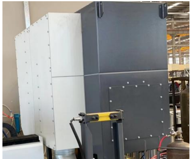
激光切割自带除尘器
