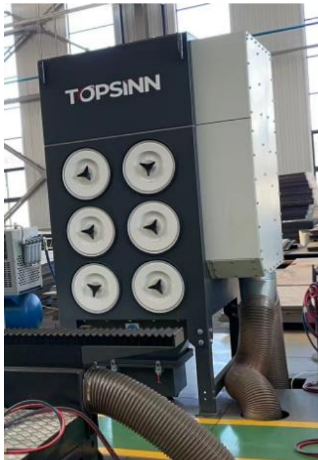
滤筒除尘器（手动焊接、等离子/火焰切割）
